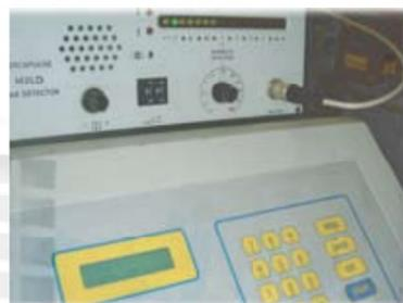
Nella fase finale ogni singolo essiccatore viene accuratamente testato per garantire la corrispondenza ai dati di progetto e la conformità sia agli standard prestazionali di sicurezza dei differenti mercati di destinazione.
